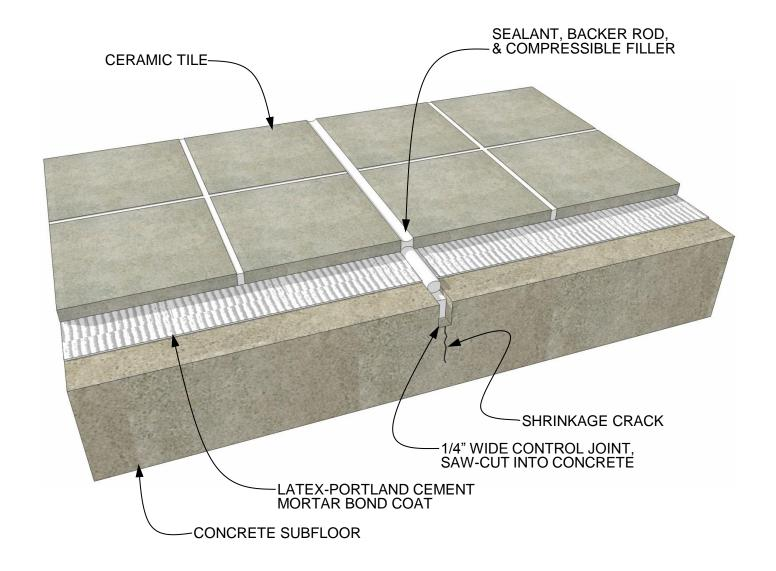
FLOOR TILE EXPANSION JOINT OVER CONCRETE CONTROL JOINT
