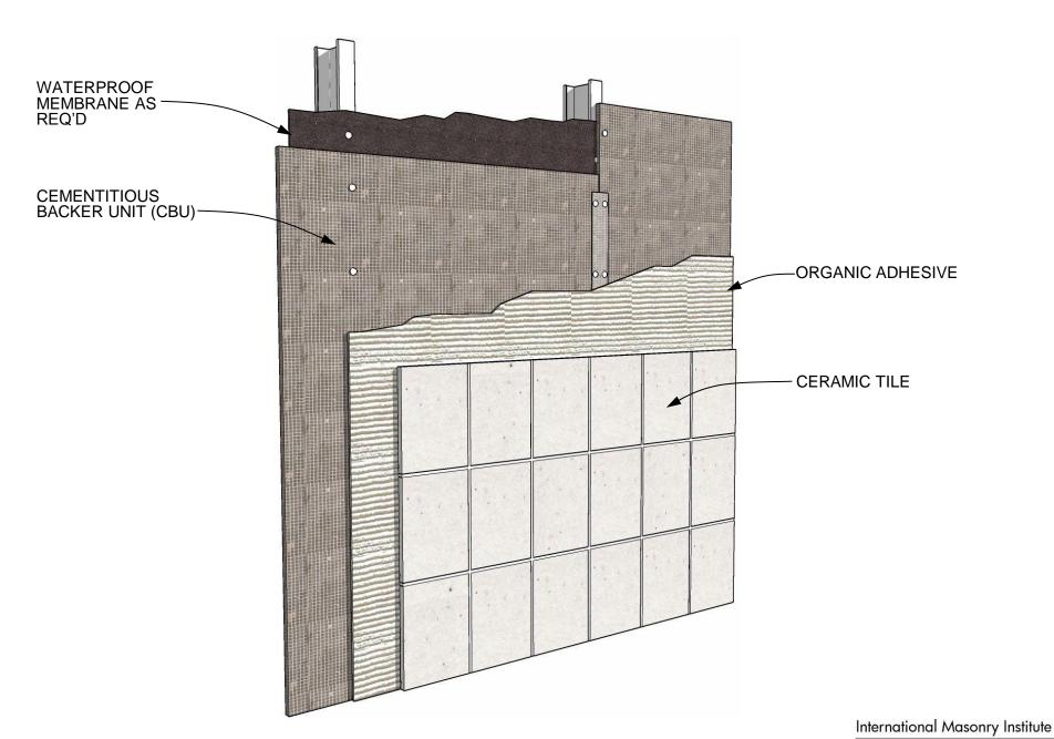
WALL TILE MASTIC ON CBU OVER STEEL STUDS
