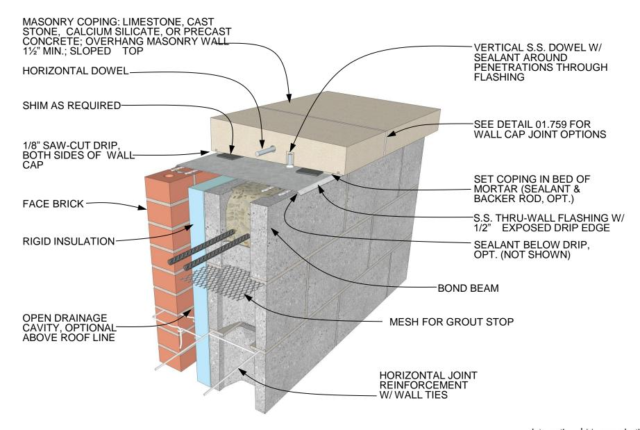
MASONRY WALL CAP VERTICAL & HORIZONTAL DOWELS
