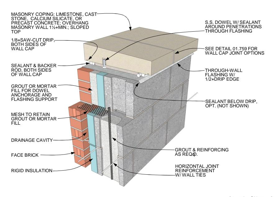
MASONRY WALL CAP FILLED CAVITY
