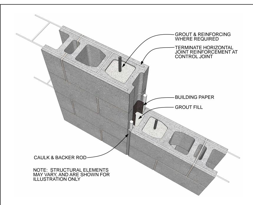
CONTROL JOINT GROUT FILL
