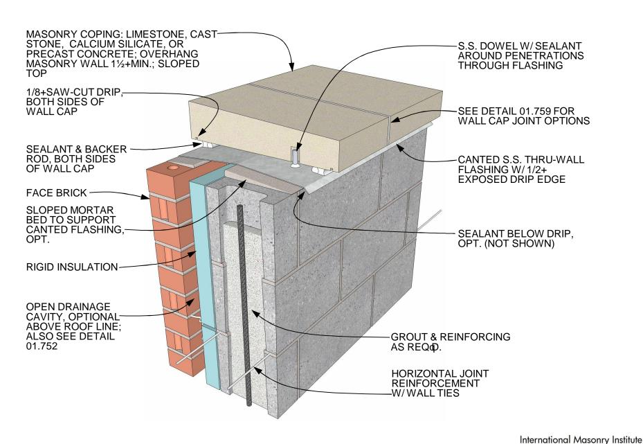
MASONRY WALL CAP OPEN CAVITY
