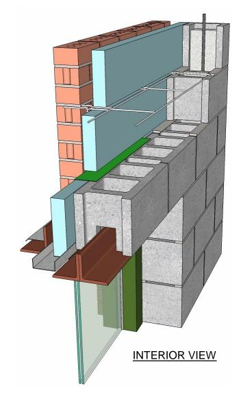
HEAD DETAIL STEEL LINTEL W/ DOUBLE ANGLE
